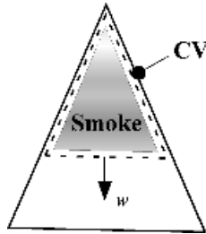
Figura 3.10 Um volume de controle envolvendo uma camada de fumaça em expansão em um compartimento
