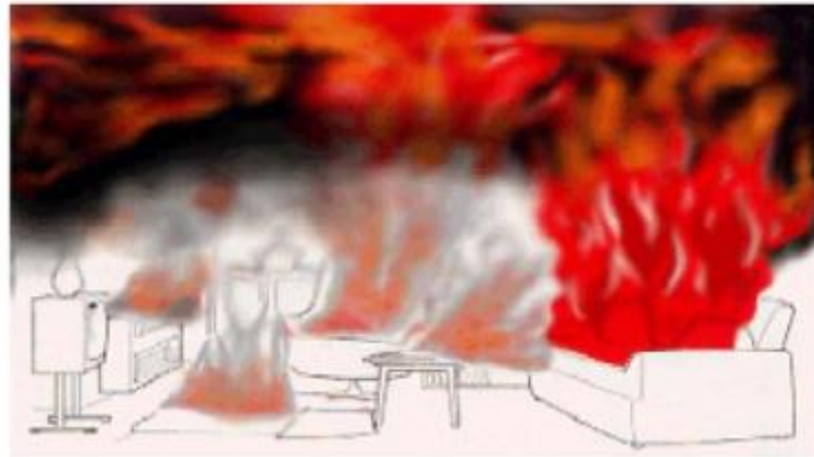
FIGURA 4 - FLASHOVER , fogo excede 20KW/m 2 - temperatura entre 483°C e 649°C.
