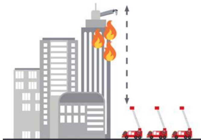
FIGURA 13- Partes protegidas do Spraysafe da estrutura que os bombeiros não podem alcançar.
